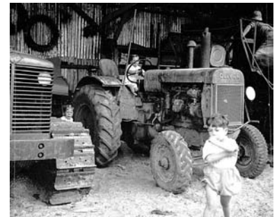
האוליבר: הטרקטור הראשון במחנה. עבד על נפט בלבד והונע במנואלה. אחרי 25 שנות שרות עבר למגרש הגרוטאות בגן "שקד"
